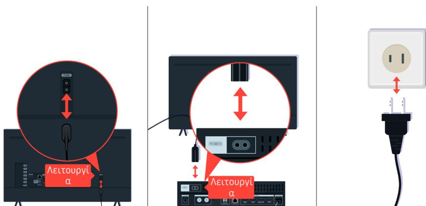
Πρώτα αποσυνδέστε και επανασυνδέστε τα καλώδια ρεύματος και HDMI στο πίσω μέρος της τηλεόρασης ή της συσκευής One Connect (OC) και, στη συνέχεια, αποσυνδέστε το καλώδιο ρεύματος και συνδέστε το ξανά στην πρίζα τοίχου.
