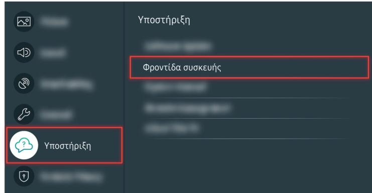
Για να ελέγχετε την έξοδο ήχου, επιλέξτε > Ρυθμίσεις > Υποστήριξη > Φροντίδα συσκευής > Αυτοδιάγνωση > Δοκιμή ήχου.
