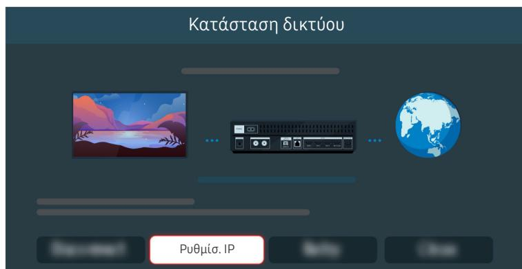
Αν αυτό το πρόβλημα παραμένει, επιλέξτε > Ρυθμίσεις > Γενικές > Δίκτυο > Κατάσταση δικτύου > Ρυθμίσ. IP για να μεταβείτε σε έναν διαφορετικό διακομιστή DNS. Αν εκτελεστεί μια δοκιμή, ακυρώστε την και επιλέξτε Ρυθμίσ. IP.
