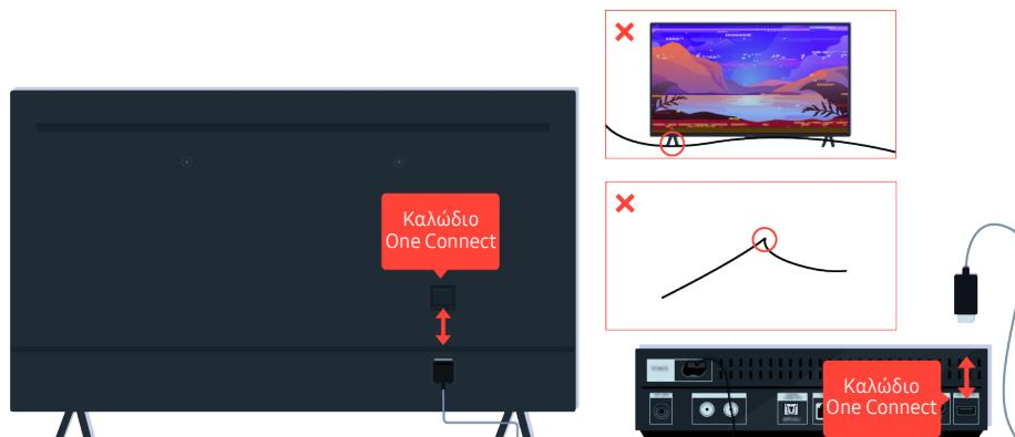
Αν το πρόβλημα παραμένει και η τηλεόραση χρησιμοποιεί το Καλώδιο One Connect, αποσυνδέστε και επανασυνδέστε το Καλώδιο One Connect στην τηλεόραση και τη συσκευή One Connect (OC). Βεβαιωθείτε ότι το καλώδιο του Καλώδιο One Connect δεν συνθλίβεται και δεν είναι λυγισμένο υπερβολικά.
