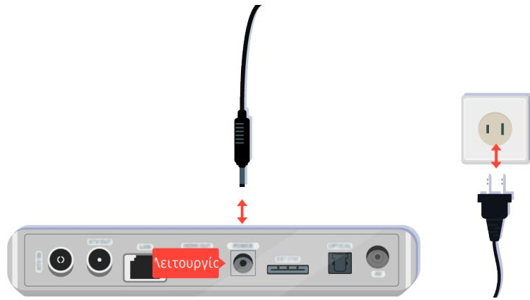
Αν δεν ενεργοποιείται, βεβαιωθείτε ότι το καλώδιο ρεύματος είναι συνδεδεμένο σωστά στη συσκευή και στην πρίζα τοίχου.
