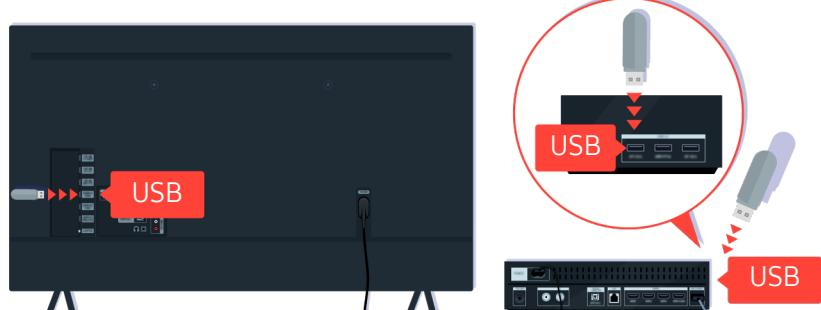
Εισαγάγετε τη συσκευή USB στην υποδοχή USB, στο πίσω μέρος της τηλεόρασης ή στο πλαϊνό μέρος της συσκευής One Connect.
