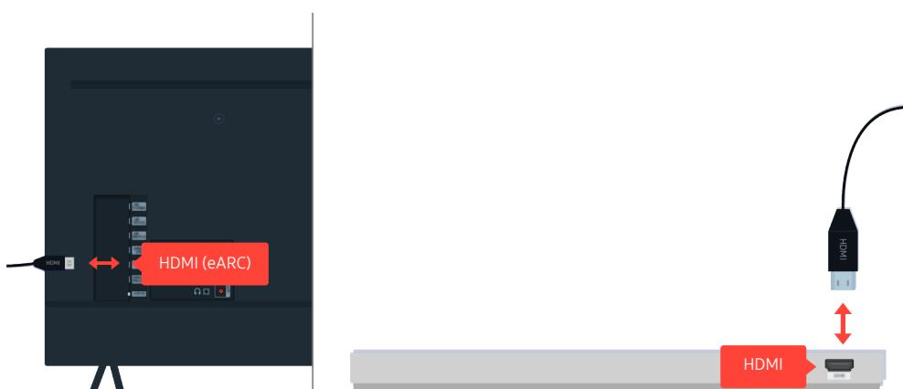
Αν δεν ακούγεται ήχος από τη συσκευή Sound Bar και αυτή είναι συνδεδεμένη στην τηλεόραση με ένα καλώδιο HDMI, ελέγξτε την υποδοχή HDMI (eARC) στο πίσω μέρος της τηλεόρασης.
