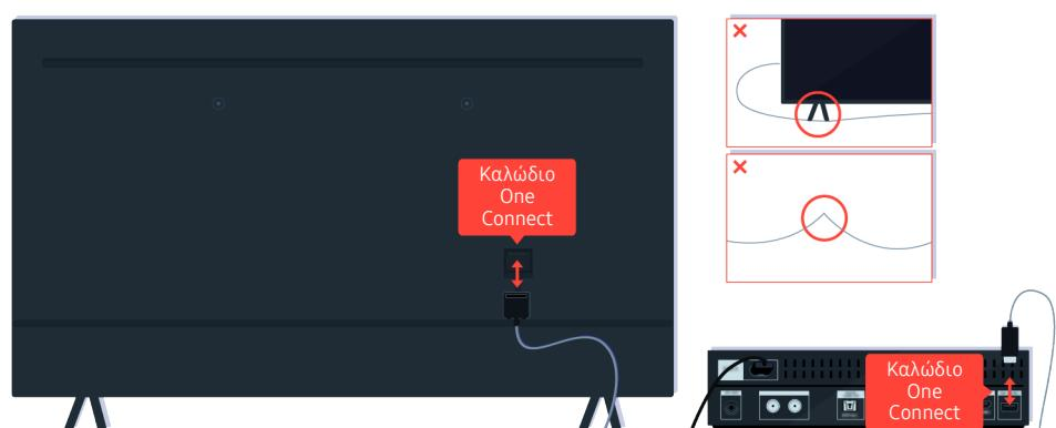
Αποσυνδέστε και επανασυνδέστε το καλώδιο One Connect ανάμεσα στην τηλεόραση και τη συσκευή One Connect (OC). Βεβαιωθείτε ότι το καλώδιο του One Connect δεν συνθλίβεται και δεν είναι λυγισμένο υπερβολικά.
