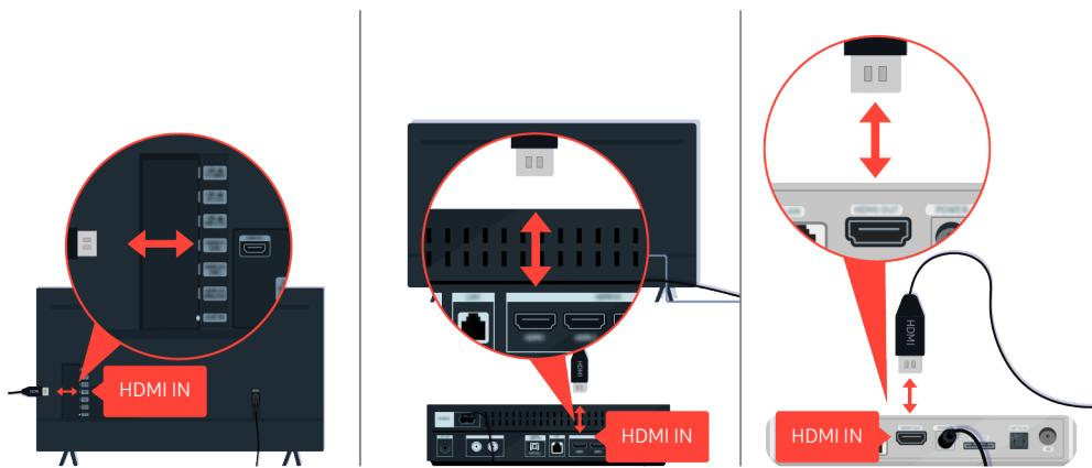
Πρώτα αποσυνδέστε και επανασυνδέστε τα καλώδια ρεύματος και HDMI στο πίσω μέρος της τηλεόρασης ή της συσκευής One Connect (OC) και, στη συνέχεια, αποσυνδέστε το καλώδιο ρεύματος και συνδέστε το ξανά στην πρίζα τοίχου.
