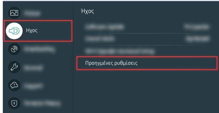
Αν η δοκιμή εντοπίσει κάποιο πρόβλημα, επιλέξτε > Ρυθμίσεις > Ήχος > Προηγμένες ρυθμίσεις > Επαναφορά ήχου.
