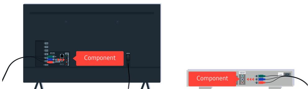
Αν χρησιμοποιείτε ένα καλώδιο σήματος συνιστωσών, βεβαιωθείτε ότι τα έγχρωμα βύσματα είναι συνδεδεμένα στις αντίστοιχες υποδοχές της εξωτερικής συσκευής και της τηλεόρασης.
