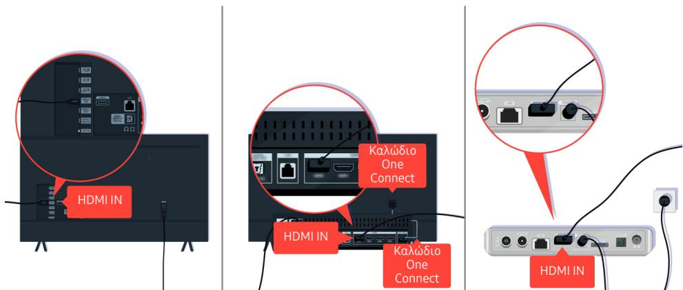
Ελέγξτε τη σύνδεση του καλωδίου HDMI στην τηλεόραση ή στη συσκευή One Connect.
