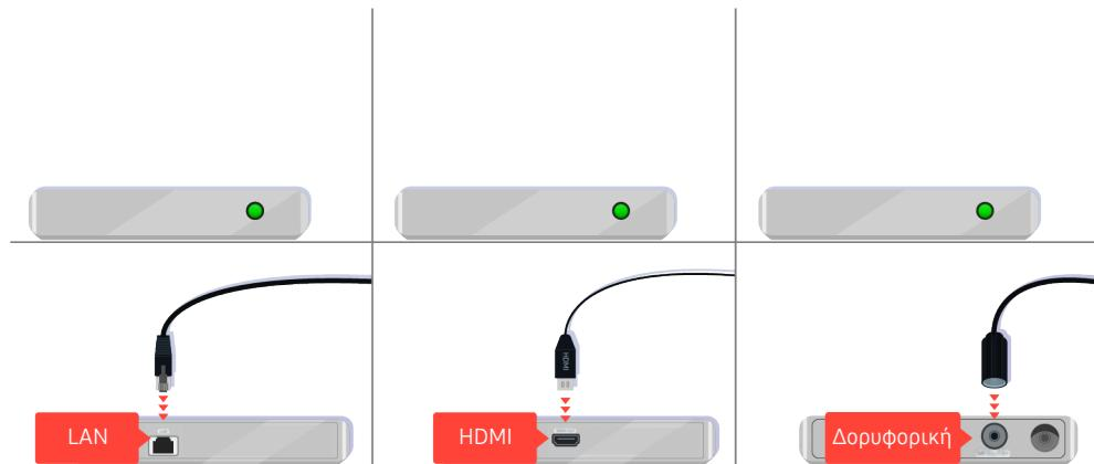
Αν χρησιμοποιείτε μια συσκευή set-top box, ελέγχτε τις συνδέσεις των καλωδίων. Το καλώδιο που πρέπει να ελέγχεται εξαρτάται από τον τύπο της συσκευής set-top box.
