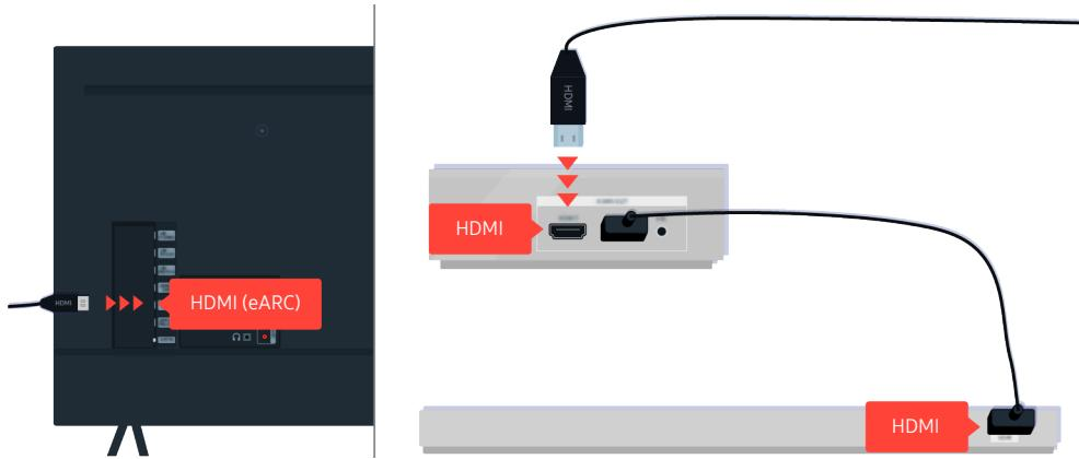
Αν η συσκευή Sound Bar είναι συνδεδεμένη σε έναν δέκτη και ο δέκτης είναι συνδεδεμένος στην τηλεόραση χρησιμοποιώντας ένα καλώδιο HDMI, ελέγξτε την υποδοχή HDMI στο πίσω μέρος της τηλεόρασης. Το καλώδιο πρέπει να είναι συνδεδεμένο στη θύρα HDMI (eARC) της τηλεόρασης.
